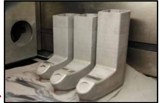
Ylimääräinen jauhe poistetaan
